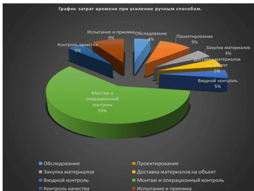
Рис.3. График затрат времени при усилении строительных конструкций ручным способом.
