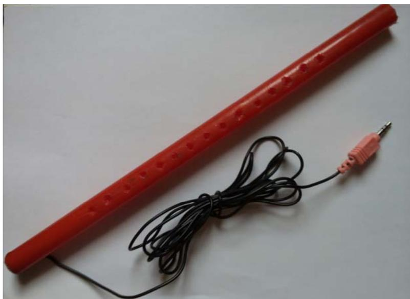
Рис. 1 – Направленный микрофон типа “бегущая волна”
