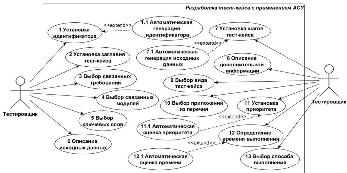
Рис. 2. – Функциональные требования к подсистеме разработки тест-кейсов
