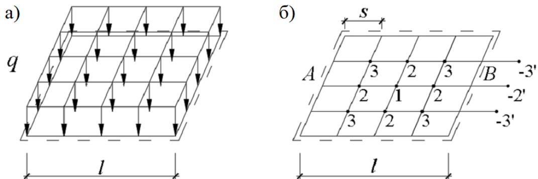
Рисунок 2 – Квадратная шарнирно опертая плита под действием равномерно распределенной нагрузки (а) с нанесенной на нее сеткой узлов (б).
