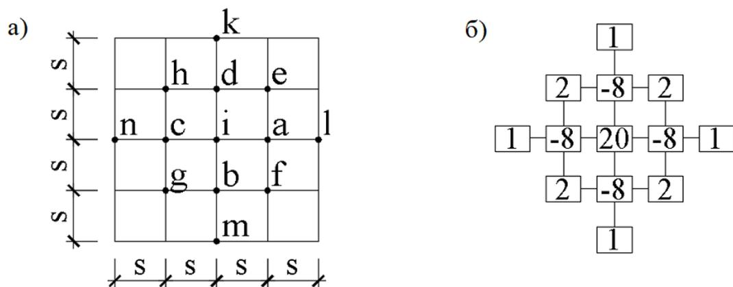
Рисунок 1 – Схема буквенного обозначения точек сетки (а) и передвижной оператор (б).
