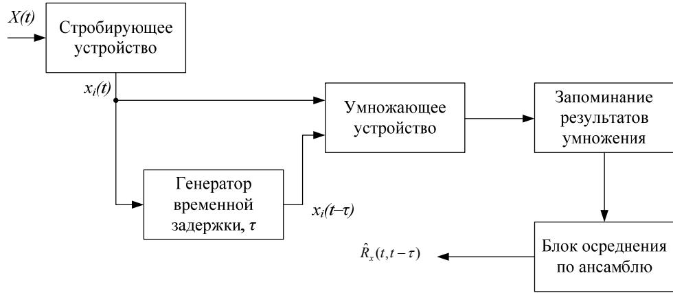
Рис. 1. – Схема измерения автокорреляционной функции нестационарного акустического вокального сигнала
