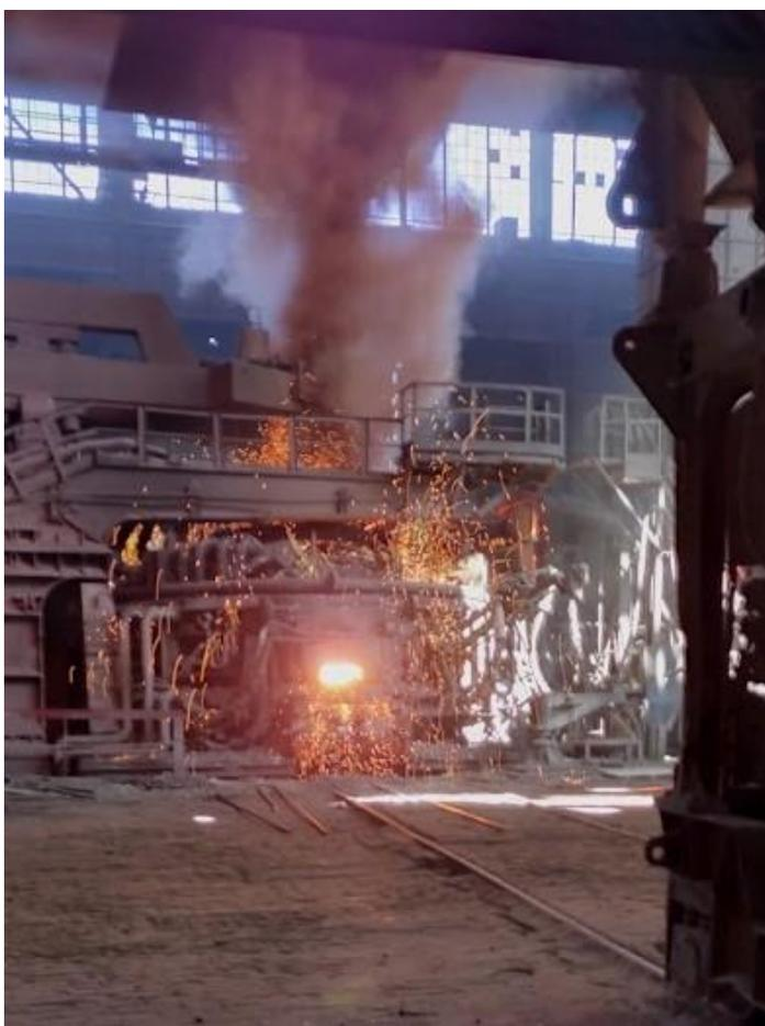
Рис.1. Выделение пылегазовоздушной смеси через межэлектродные отверстия ДСП
