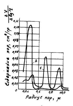
Рис. 1. Поровая структура полиэфирного полимер-раствора, поровой структурой порошкообразного поливинилхлорида, в диапазоне от 0.1 до 0.05 мкм (максимальное содержание пор размером 0.02 мкм) допускает проникновение только газообразной фазы, что не является опасным для покрытий полов. Использование низкомодульных наполнителей эффективно не только для строительных конгломератов типа полимеррастворов, но и для
