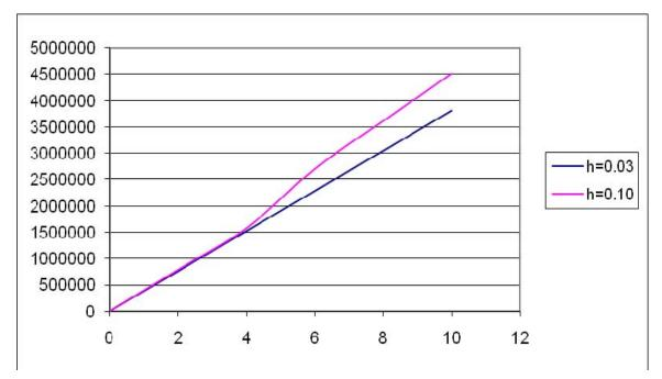
Рис. 3 - Зависимость максимальных растягивающих напряжений в покрытии от обратного перепада температур.
