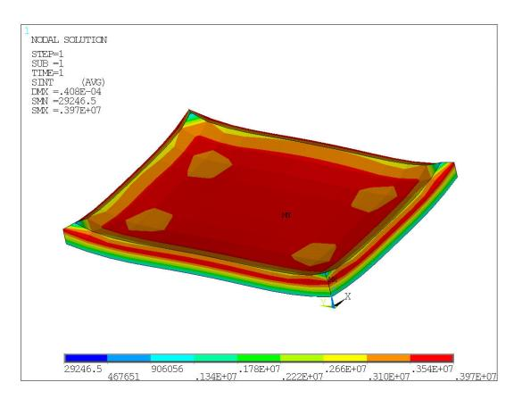
Рис. 1 - Интенсивность напряжений, Па в плите покрытия 3.5x5 м при обратном перепаде температур  $10~^{0}$ С в условиях образования трещин в швах сжатия
