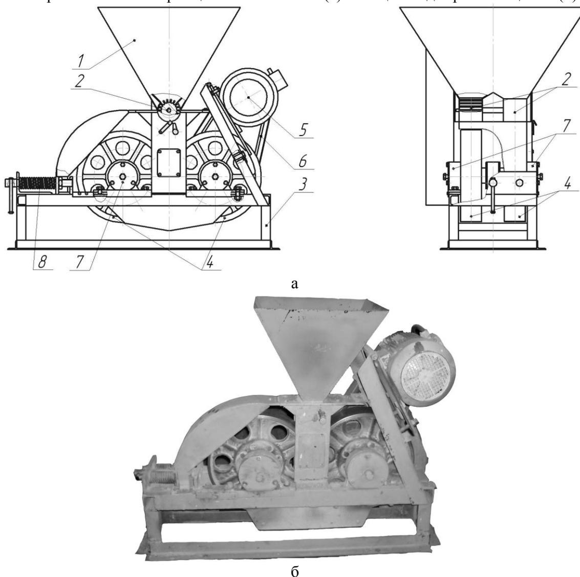
Рис. 1 Принципиальная схема (а) и общий вид (б) зерноплющилки
